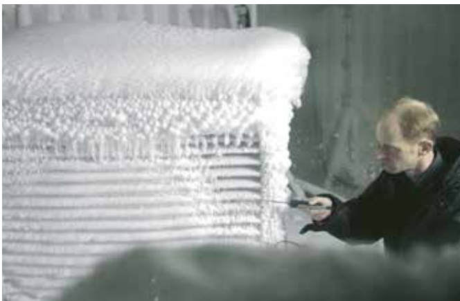
I kylrummet testas värmepumparna vid extrema temperaturer.
